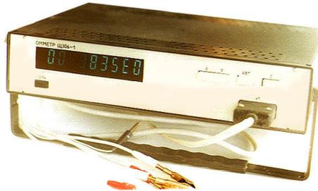
Интегрирующий прецизионный малогабаритный омметр предназначен для измерения сопротивлений в диапазоне от 100 мкОм до 1 ГОм.
